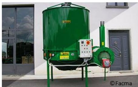
Figure 14 : Séchoir à gaz et vis sans fin
