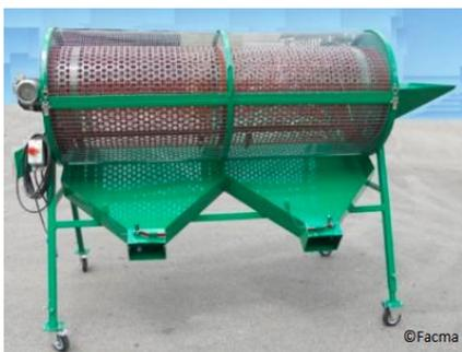
Figure 9 : Calibreuse mécanique rotative Facma
