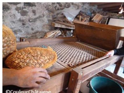
Figure 10 : Calibreuse fabrication artisanale
